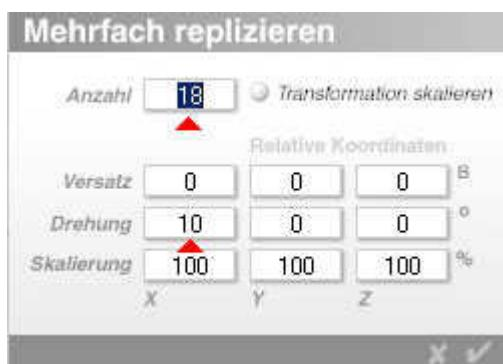
Öffnen Sie den Mehrfach replizieren Dialog erneut und stellen Sie die Werte im Dialog ein, wie gezeigt. Es werden 18 Gruppen aus Zylindern um je  $10^\circ$  in der X-Achse gedreht erstellt und Sie erhalten eine Kugel aus vielen Zylindern. Das kann eine Weile dauern ...
