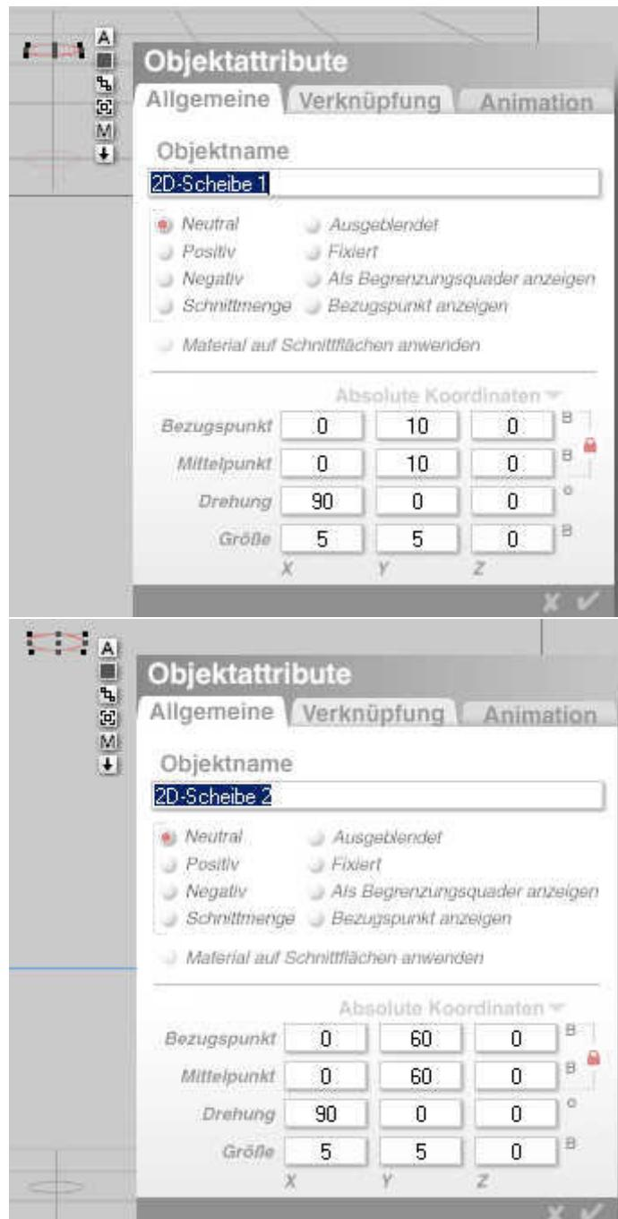
Erstellen Sie eine 2D Scheibe und stellen die Attribute so ein, wie links gezeigt. Die Scheibe wird um 90° in der X-Achse gedreht und erscheint so wie die Bodenfläche eines Zylinders.
